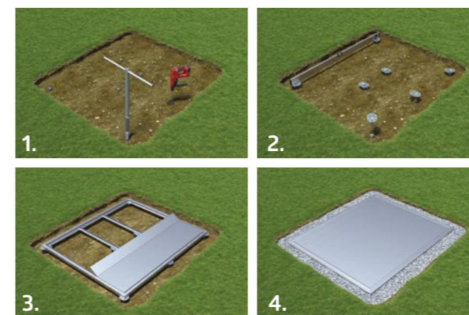
1 Bouwplaats voorbereiden en grondschroeven indraaien 3 Frame bevestigen
