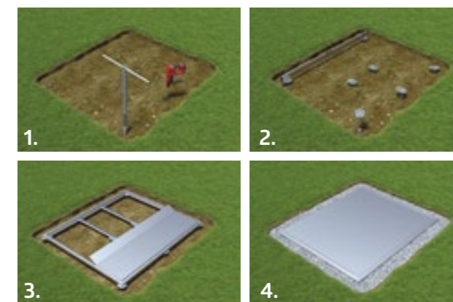
1. Bouwplaats voorbereiden en grondschroeven indraaien 2. Montageplaten aanbrengen en 3. Frame bevestigen 4. Alu-platen verleggen en bevestigen
